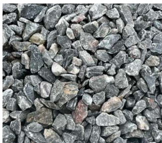
Graviers, bandes stériles sur toiture
