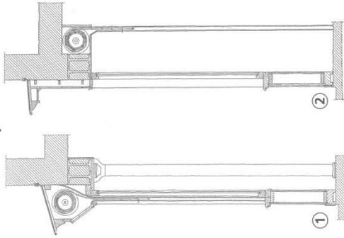
Rideau métallique sur devanture / Principe d'installation intérieure d'un rideau métallique pour devantures en applique ou feuillure
