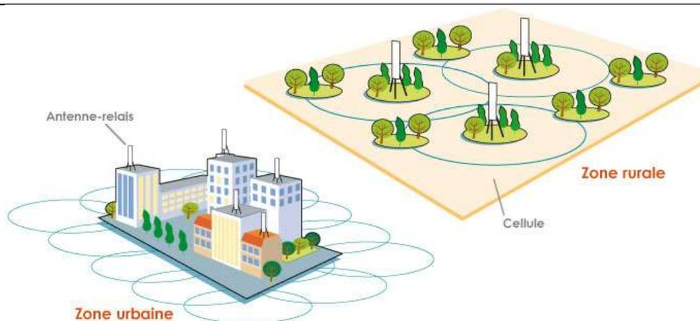
**L'antenne-relais émet des ondes dans une direction privilégiée. Ce faisceau peut être comparé à celui d'un phare qui éclaire la mer.** Les faisceaux principaux de l'antenne sont directifs et très fins (6 degrés environ) dans le plan vertical. **L'intensité du faisceau diminue très rapidement (en fonction du carré de la distance) en s'éloignant de l'émetteur.** Cf. schéma ci-dessous à titre indicatif.
